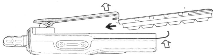
Для удаления батареи, выключите радиостанцию и снимите защитный чехол. Откройте замок батареи, затем нажмите на верхнюю часть клипсы, поднимите нижнюю часть батареи и удалите ее из радиостанции.
